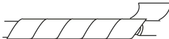
图 3.5 接线第二步-缠绕绝缘层
