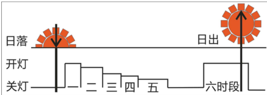
图 6.1 光控模式工作示意图
